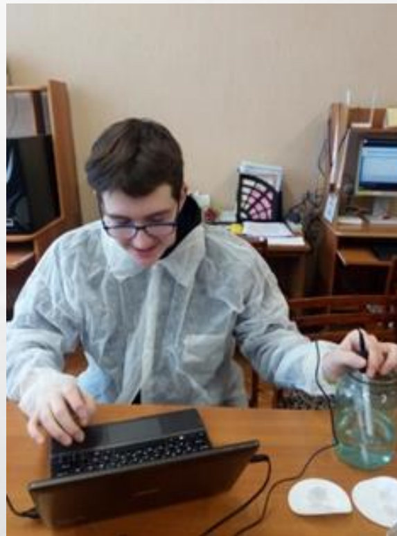
Определение электропроводности талой воды цифровым Р - датчиком электропроводности
